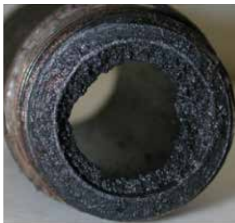
GRÁFICO 2a/b: Un hidrocarburo en un fluido de transferencia de calor de base mineral experimenta degradación térmica, lo que crea hidrocarburos más livianos con menores viscosidades y puntos de inflamación, y depósitos de carbono pesados (Gráfico 2b).
