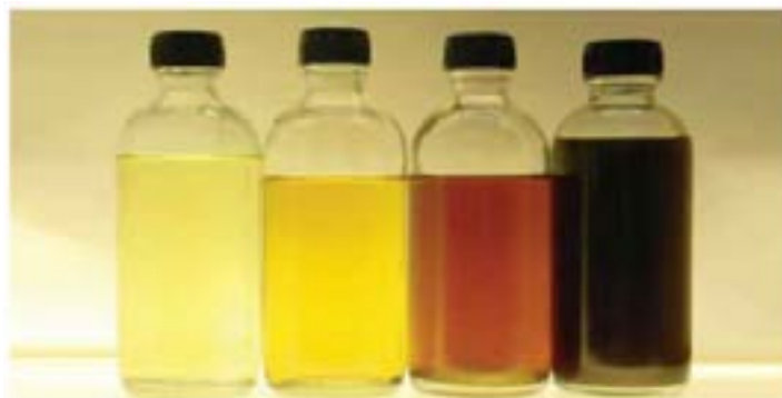
GRÁFICO 4: La decoloración progresiva ocurre cuando un fluido de transmisión de calor está expuesto al oxígeno a lo largo del tiempo.
